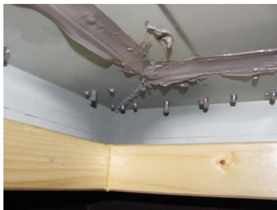
Bild 4 Anschluss Domitec® Profilbahn an Prüfungs- aufbau – Ansicht von innen
